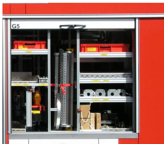
Beispiel der Lagerung Rettungsplattform im Geräteraum G5 Eine Lagerung auf dem Dach ist bei der Entnahme zu unfallträchtig
