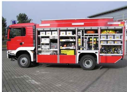
RW DIN Lagerung der feuerwehrtechnischen Beladung in Aluminium-Kisten nach DIN 14880
