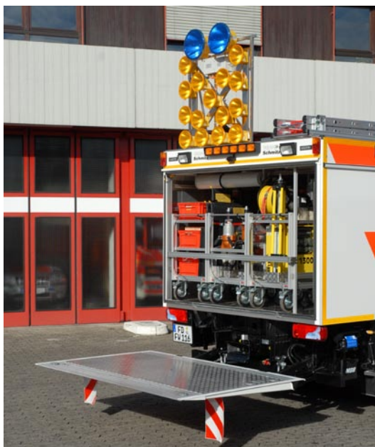
Zusatzausstattung Verkehrswarnung: Leuchtpfeilanlage „Nissen“ Typ LP 15 mit Hebe-/Senkvorrichtung mit 2-fach Halogenanlage (blau) auf dem hinteren Aufbau und geöffnetes Heck.
