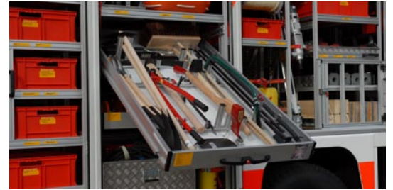
2. Schublade: Räumgeräte wie z.B. Besen, Schaufeln usw. Teile der Ölwehrbeladung nach Tabelle 2
