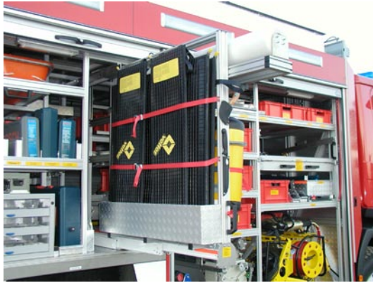
2. Schubwand: Hebekissen, Pressluftflaschen und Folienrolle mit Messer
