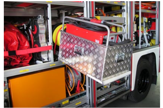
Das Plasma-Schneidergerät lagert mit dem zum Betrieb notwendigen Zubehör in einem herausnehmbaren Alu-Kasten auf einem absenkbaren Schlitten.
