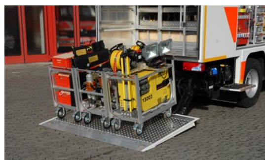
Der Geräteraum G 7 mit Heckladebordwand dient zur Lagerung von z.B. 3 fahrbaren Kleincontainer mit Totmannbremse (ständig verlastet).
