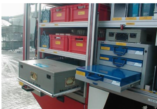
Herausnehmbare Stahlblech-Koffer in Sortimo-Tresorschrank eingebaut für Nägel, Schrauben und Kleinteile
