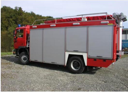
RW 3, 18 to Besonderheit: Lichtmast „Super Heavy“ am Heck angebaut mit Gasentladungslampen
