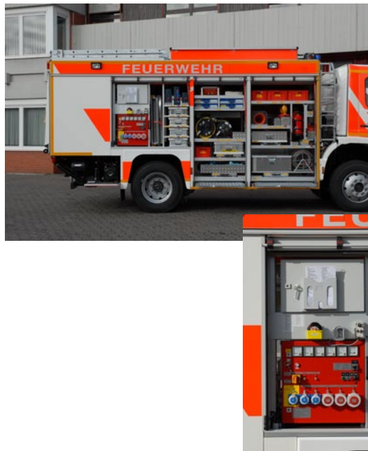
Rüstwagen Seitenansicht mit Generator - Schaltschrank und Lagerung Rettungsplattform
